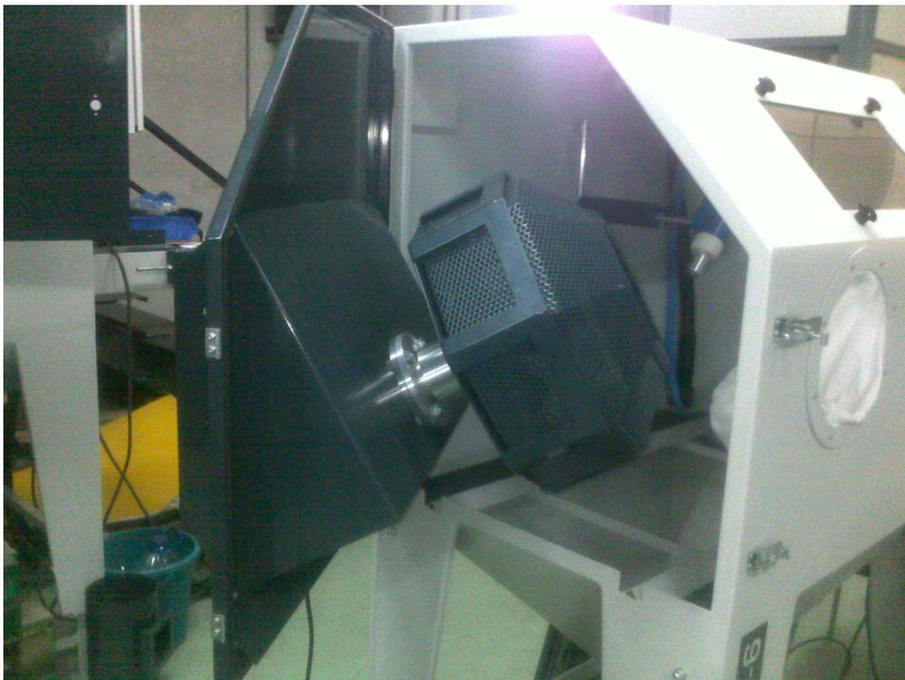
Indicada para el chorreado de piezas de tamaño pequeño como partes de motor, cárteres y piezas mecánicas en general.
